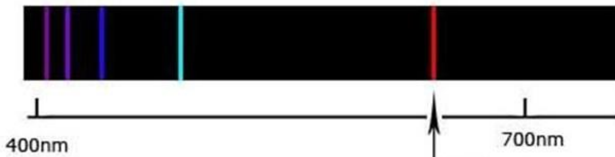
Εικόνες 6: Αυτές οι εικόνες δείχνουν τη διαφορά μεταξύ ενός συνεχούς φάσματος και των φασμάτων εκπομπής και απορρόφησης για το στοιχείο υδρογόνο. Ένα φάσμα εκπομπής δείχνει φωτεινές γραμμές στα
